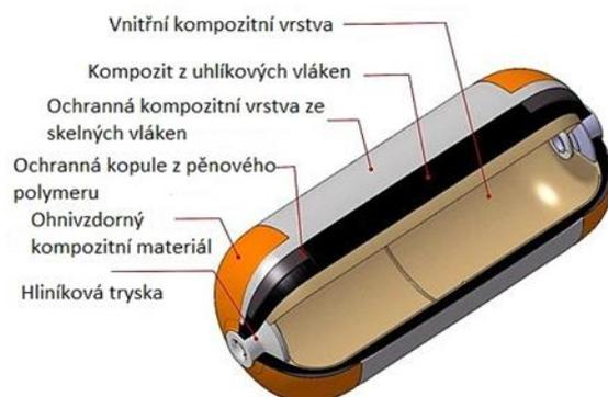
Abb. 5: Querschnitt der Wasserstoffflasche
