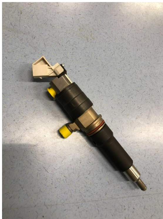
Här beskrivs ett exempel, denna dubbla injektor är utvecklad av företaget West port. (Bild 23)
