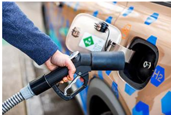
Påfyllningsmunstycket är mycket likt det som används för andra fordonsgasar (bild 12).
