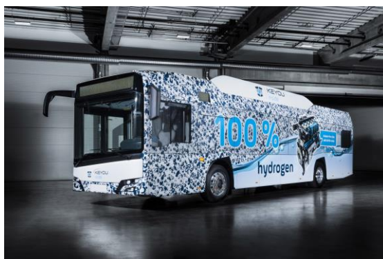
En buss som drivs av vätgas med en konventionell motor, Keyou är företaget bakom den (Bild 8)
