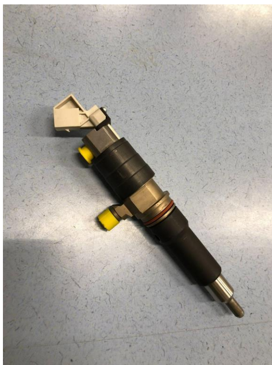
Zde jeden příklad, duální vstřikovač vyvíjen společností West port. (obrázek 23)
