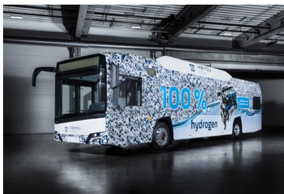
Autobus poháněný vodíkem s konvenčním motorem, za jehož výrobou stojí společnost Keyou (obrázek 8)
